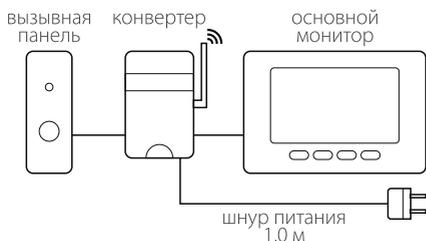
**!** Конвертер подходит к любому видеодомофону без функции переадресации вызова на смартфон. Установив данное устройство, Вы получите эту функцию, присутствующую в более дорогих моделях видеодомофонов.
