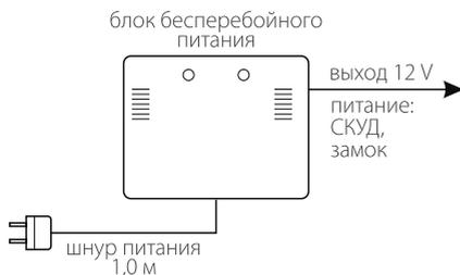
**!** Блок бесперебойного питания (ББП) временно обеспечивает питанием системы контроля доступа при перебоях в подаче электроэнергии, а также защищает оборудование от скачков напряжения в сети.
