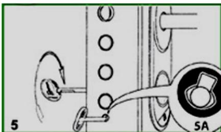
Приспособление для перекодировки поворачиваем в изначальное положение (в сторону подъезда), как он был до момента всех произведенных работ (рис. 5а).
