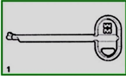
Вставляем монтажный или старый ключ в замочную скважину с внешней стороны. Ригели замка должны быть полностью убраны в замок (замок открыт). Поворотом ключа убираем ригель защелки и удерживаем ключ в этом положении, при этом основные ригели дополнительно углубятся на 3-4 мм
