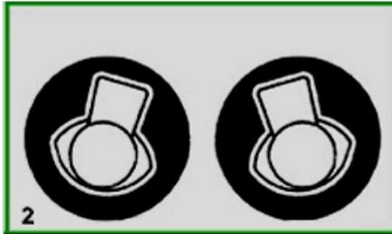
Удерживая ключ в таком положении, вставляем приспособление для перекодировки (рис. 1) в предназначенное для этого отверстие (рис. 2), расположенное под ригелями в торце замка и поворачиваем его до упора в сторону квартиры (приблизительно на 30 градусов).
